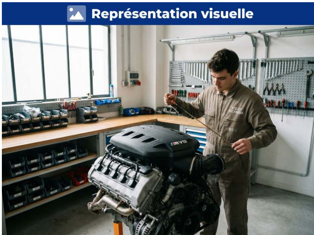
Mesurer le niveau d'huile entre les repères pour un bon fonctionnement moteur
